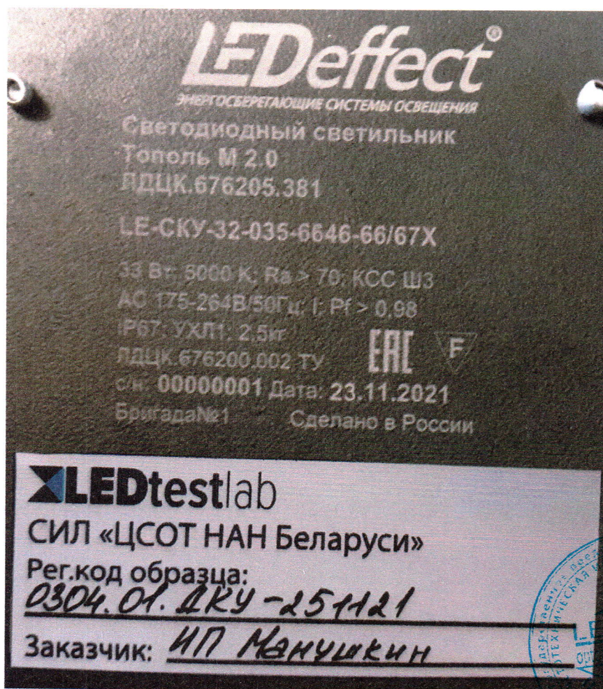
Рисунок 6 – Фотография маркировки и регистрационной этикетки образца светильник светодиодный Тополь М2.0 LE-СКУ-32-035-6646-66/67X
